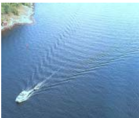
Rys. 2a. Fala dziobowa, towarzysząca łodzi poruszającej się z prędkością większą od prędkości fal na wodzie
